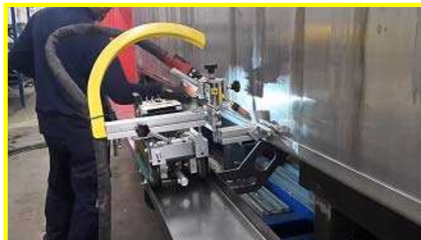
Saldatura esterna casse di alluminio
