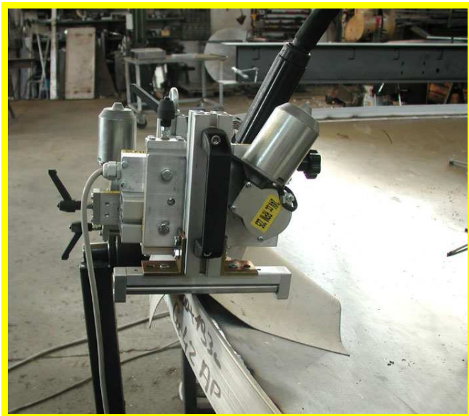
WALL CARRY SILOS IN SALDATURA
