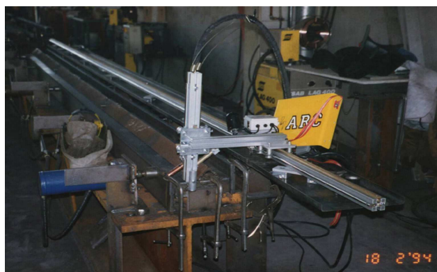
SALDATURA TRAVI H
