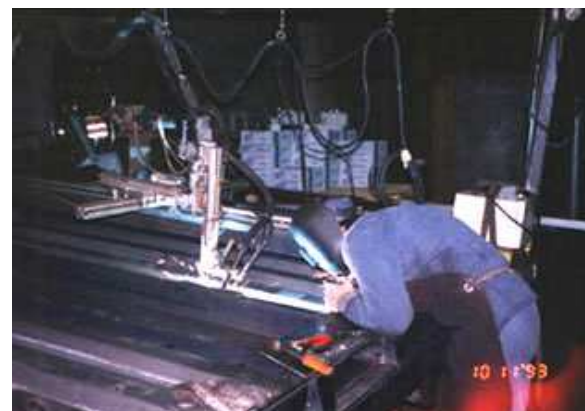
SALDATURA PARETI CONTAINERS
