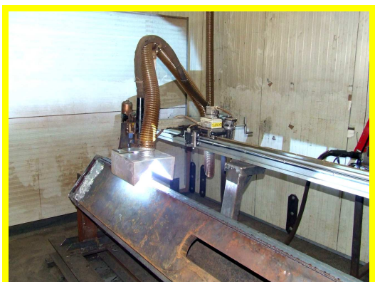
SALDATURA TELAIO CINGOLATI
