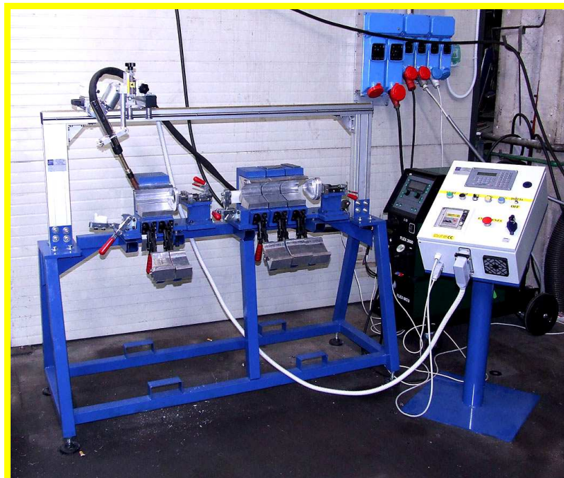
Postazione di saldatura silenziatori gestita con PLC
